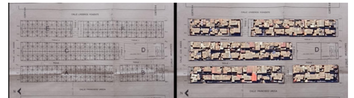
Fig. 3 - “Lote 11” Proyecto original y realidad actual con ampliaciones informales. Fuente: Elaboración propia.
